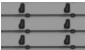
图 7 经过光刻工艺后形成的光刻胶图样
